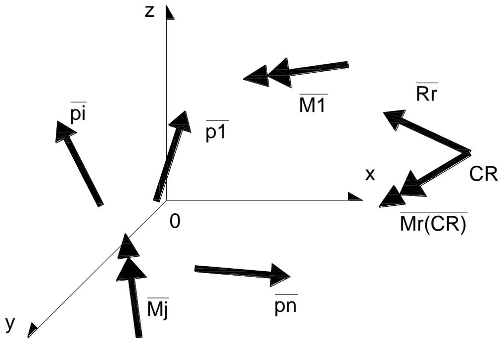
De la reducción al punto  $CR$ , siendo  $A_i$  puntos de las rectas de acción de las fuerzas  $\vec{p}_i$  las condiciones de equivalencia son,
