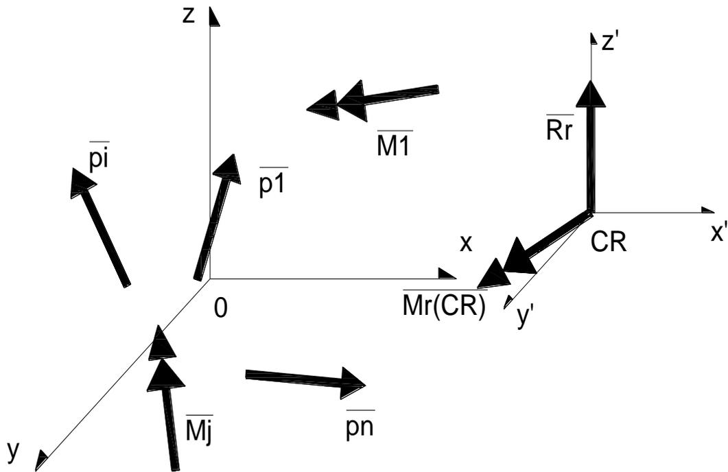
Luego, una alternativa, es plantear ecuaciones de proyecciones de momentos respecto de una terna alternativa  $(x'; y'; z')$ , y reemplazar una ecuación de sumatoria de las proyecciones de componentes de fuerzas, por ejemplo respecto del eje z, transformando el sistema en,
