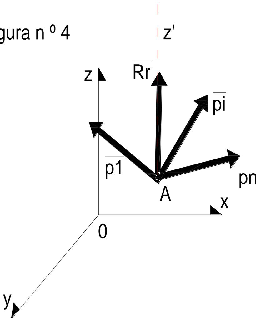
Podemos reemplazar una ecuación de sumatoria de las proyecciones, por ejemplo respecto al eje z, por una ecuación de sumatoria de los momentos respecto de un eje no coplanar con la
