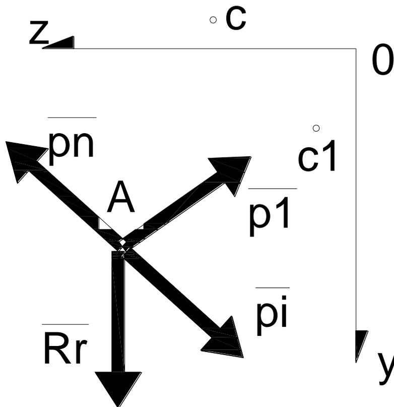
En una primer alternativa, reemplazamos una ecuación de sumatoria de proyecciones de fuerzas, por ejemplo, sumatoria de fuerzas sobre eje  $y$  por una sumatoria de momentos respecto de un punto  $c$ , con la condición que  $c$  no debe formar con el punto de concurrencia  $A$  una recta normal al eje de proyección restante, es decir  $z$ , por idénticas condiciones al caso a) de sistema plano de fuerzas generales.
