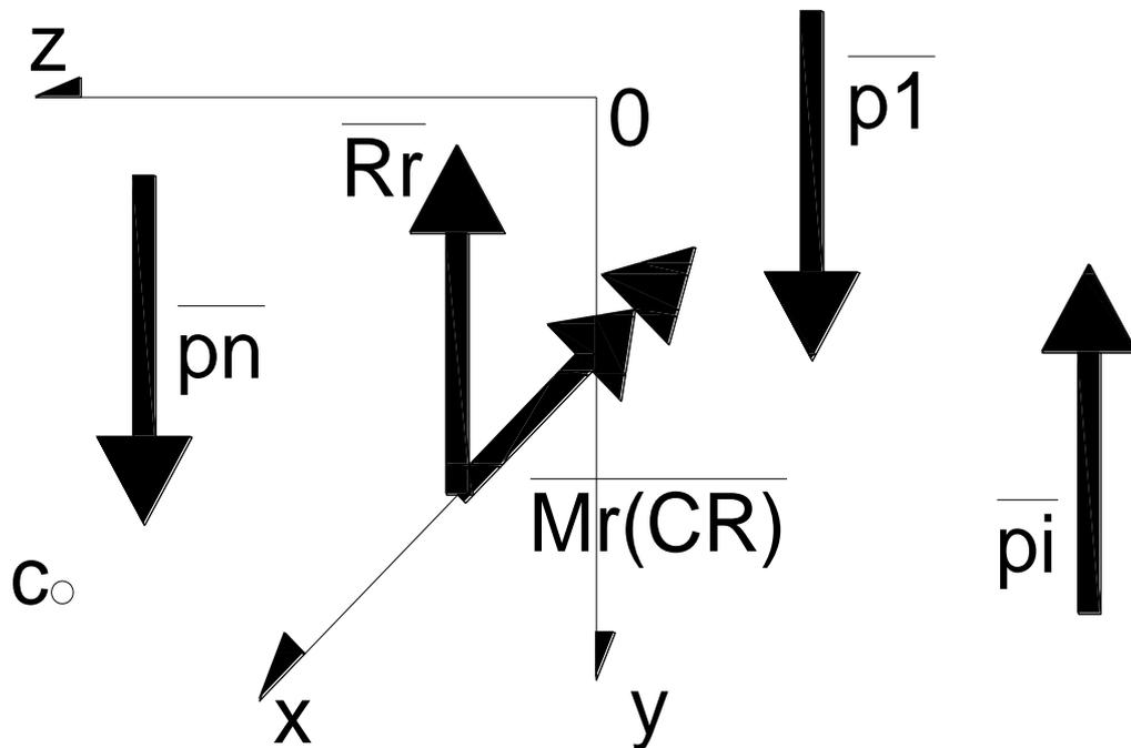
Se puede reemplazar la ecuación de sumatoria de las proyecciones en y con una ecuación de sumatoria de momentos respecto de un punto c, con la condición que **c** y **CR** no formen una recta paralela a la dirección de las fuerzas, pues en ese caso se obtendrían dos ecuaciones equivalentes o proporcionales de sumatoria de momentos.
