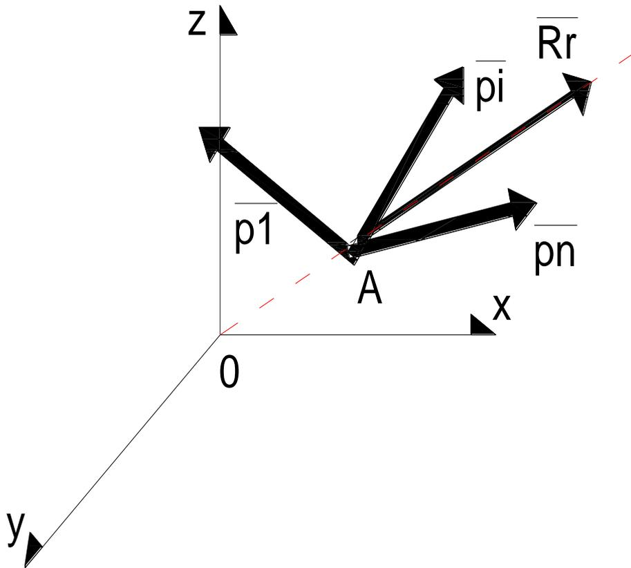
$$(10) \left\{ \begin{array}{l} \sum Mom_{xx} = 0 \\ \sum Mom_{yy} = 0 \\ \text{Sumatoria de proyecciones de fuerzas respecto de un eje no } \perp \text{ con la posible direcci3n} \\ \text{de } \vec{R}_R \text{ definida por las dos ecuaciones anteriores igualadas a 0} \end{array} \right.$$
