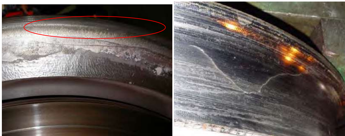
Figura 28: Fisuras por fatiga sub-superficial que se han propagado sobre la cara de la llanta, [22].
