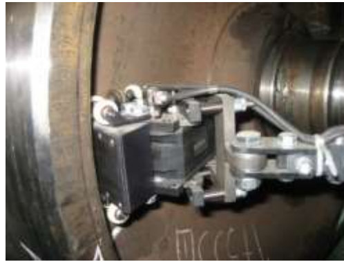
Figura 63: Dispositivo de inspección por corrientes inducidas en ruedas de tren, [39].
