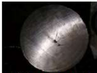
Figura 78: Defecto volumétrico y fisuras radiales, [70].
