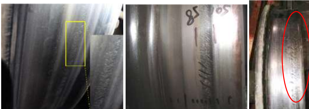
Figura 21: a) Fisuras en zona 1 por RCF. Se destaca la orientación que forman estas fisuras con respecto al eje axial de la rueda, [13, 16].
