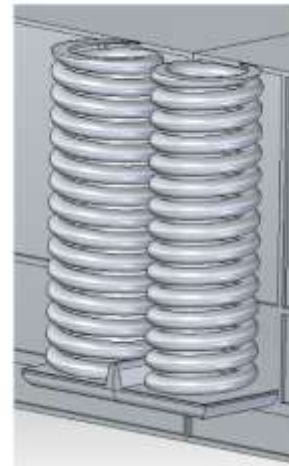
Figura 10: Sistemas de suspension. Izquierda: bieletas. Derecha: Secundaria de resortes.
