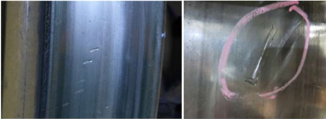
Figura 39: Marcas repetidas debidas a cuerpos extraños en el riel; hendidura orientada longitudinalmente.
