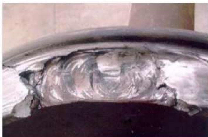
Figura 53: Fallo en rueda por shattering.
