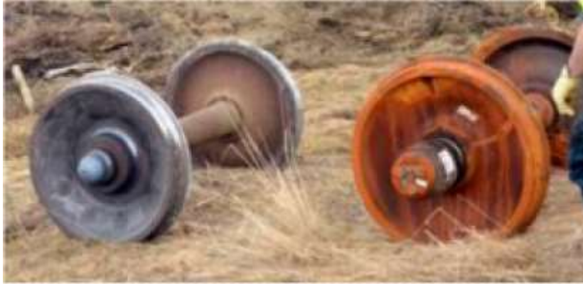
Figura 37: Sobrecalentamiento de rueda indicado por enrojecimiento, [27].
