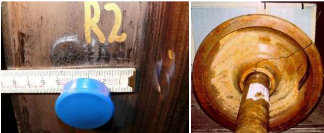
Figura 38: Fisura lateral y llanta completamente fisurada tras un sobrecalentamiento, [26, 28].
