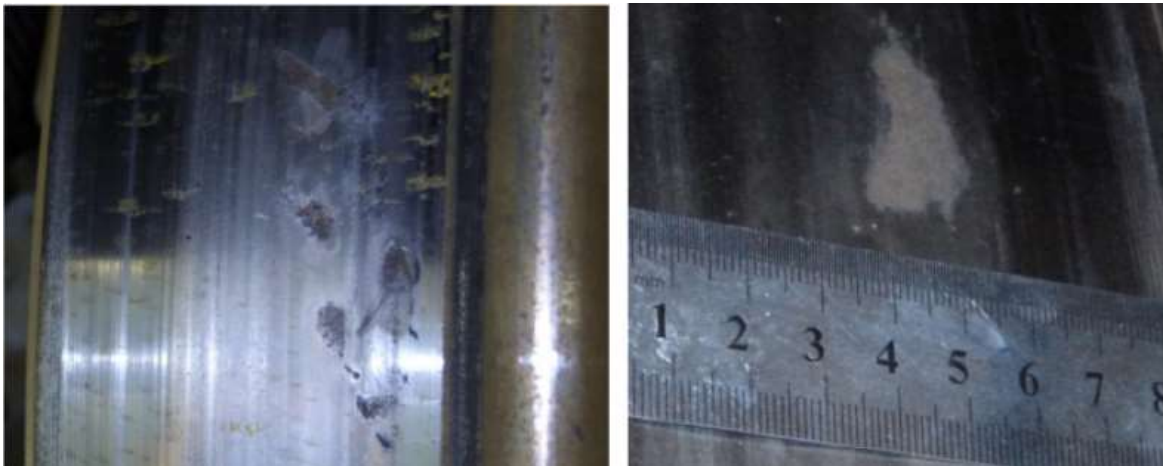
Figura 40: Nieve induce este fenómeno en la banda de rodadura, [16].
