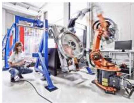
Figura 70: Prueba de defectos superficiales en ruedas de ferrocarril por termografía de inducción utilizando un robot, [48].
