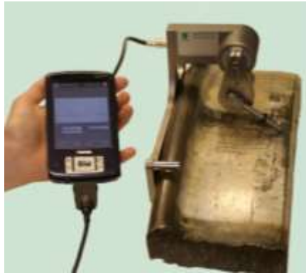
Figura 60: Miniprof ® , instrumento para realizar la medición digital del perfil de una rueda, [36].
