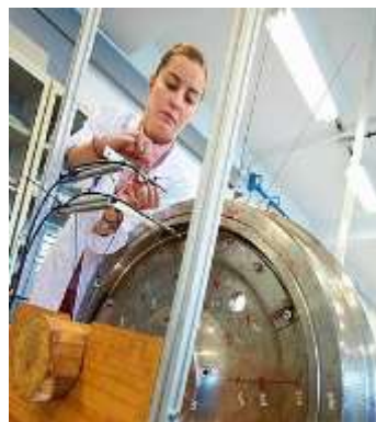
Figura 61: Foto de ensayo de emisión acústica con transductores piezoeléctricos.
