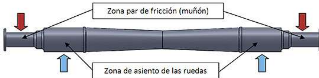
Figura 76: Esquema de eje ferroviario con las zonas de asiento y muñón, [69].
