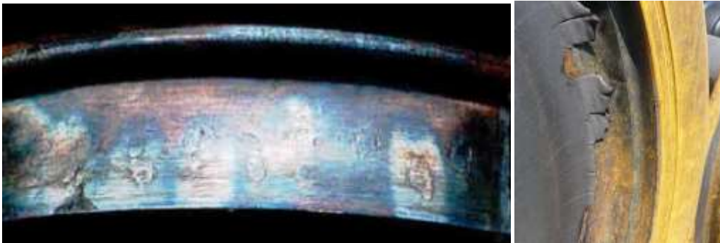
Figura 36: Rueda que ha sufrido una sobrecarga térmica, destaca la decoloración y pérdida de la pintura, [25, 26].
