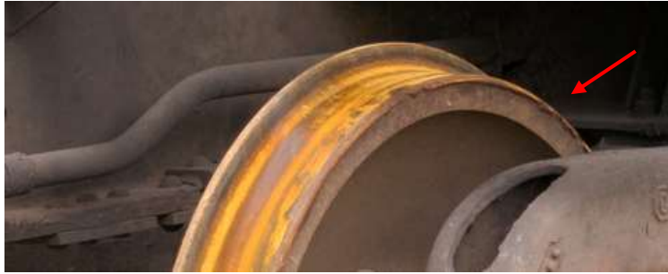
Figura 30: Un ejemplo clásico de Tread Roll Over el cual ha creado un labio que sobresale de la cara de la llanta.
