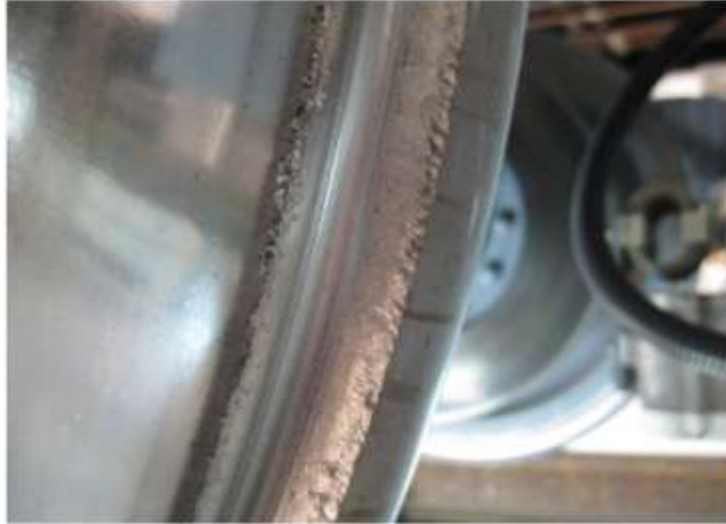
Figura 15: Imagen de rueda que ha sufrido un desgaste severo [10].
