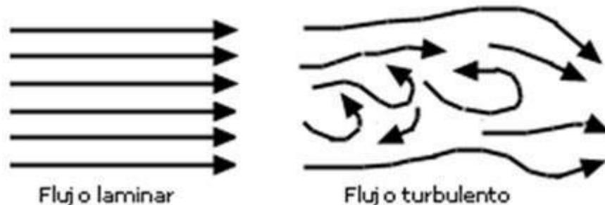
Figura 2.3.1: Flujo laminar / turbulento
