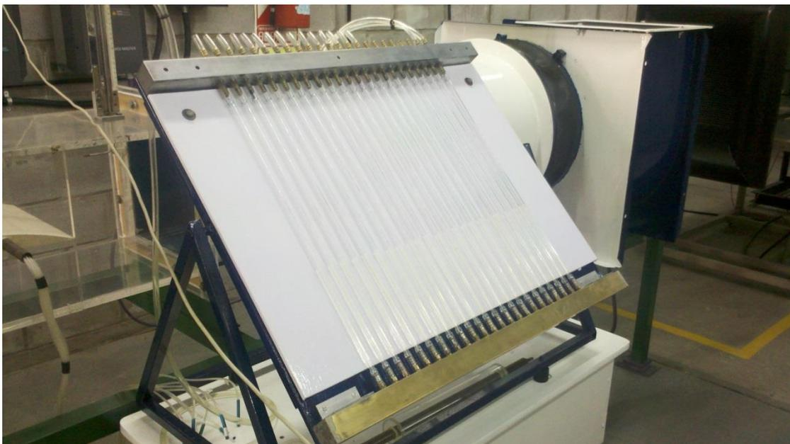
**Figura 3.1.2: Manómetro diferencial con la inclinación de 45°.**
