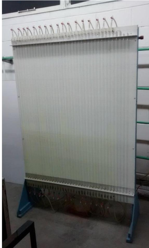
Figura 3.1.3: Manómetro diferencial usado en la práctica. Nótese la conexión superior para presurizar al sistema.
