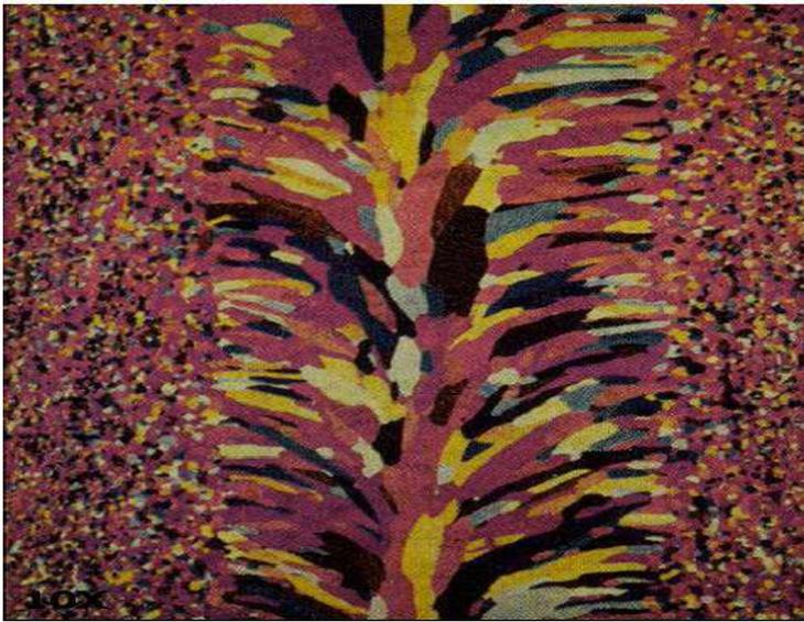
Fotomicrografía de una lámina de 80%Nb – 10%Hf – 10%W soldada mediante haz de electrones.
