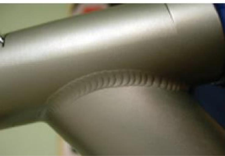
Básicamente, la gran ventaja de este método es la obtención de cordones más resistentes, dúctiles y menos sensibles a la corrosión, ya que el gas protector impide el contacto entre la atmósfera y el baño de fusión; además, simplifica notablemente el soldeo de metales no ferrosos, por no requerir el empleo de desoxidantes, lo que evita las inclusiones de escoria y el consecuente riesgo de corrosión en la zona soldada.
