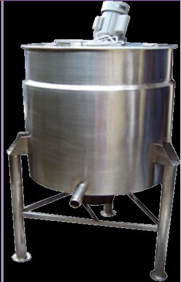
Equipo que permite efectuar operaciones tales como pasteurización de la leche, cuaje para queso y maduración del yogurt. Esta construida en acero inoxidable, es una unidad compacta con tapa; posee una capacidades distintas según modelos; tiene controles con pirómetro; el agitador tiene 4 paletas y motor de 1HP.
