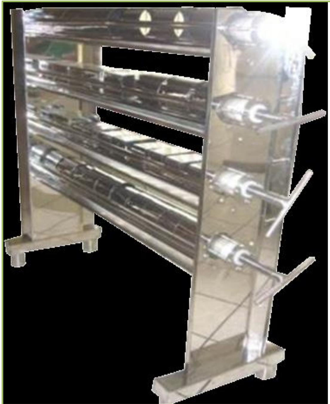
Prensa para queso , construida en acero inoxidable, se utiliza para realizar el prensado horizontal de los quesos en molde Tiene una capacidad de 30 moldes a más, contiene una bandeja para el suero, también en acero inoxidable.
