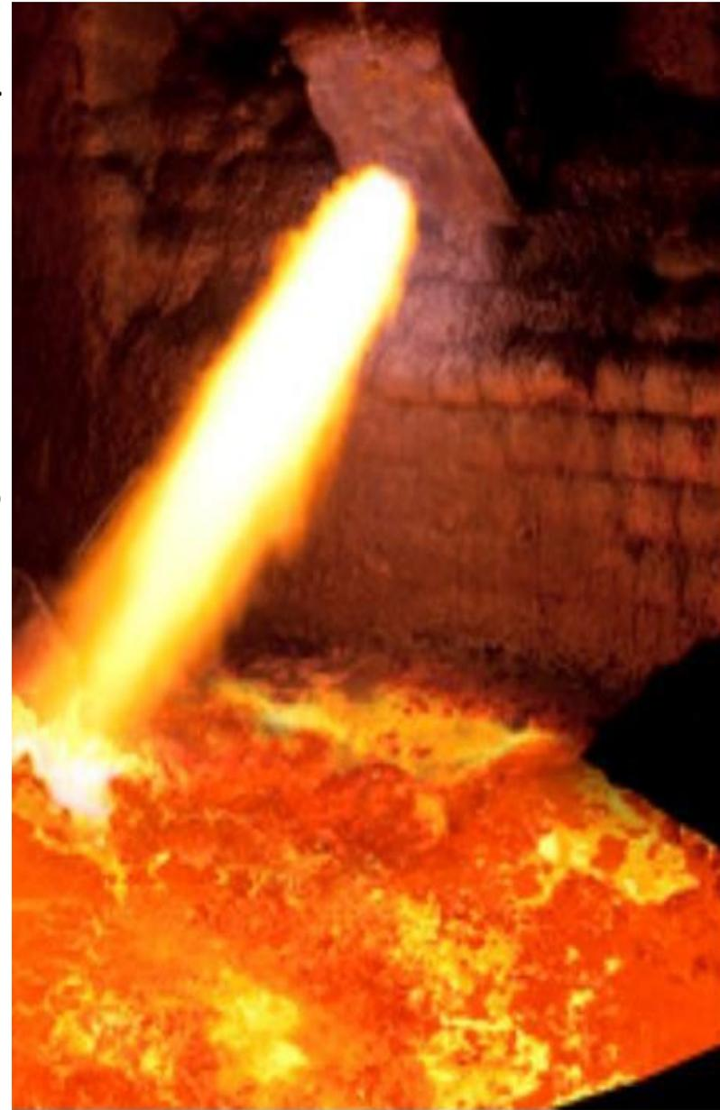
Unidad SIS en modo quemador Foto: SMS Siemag
