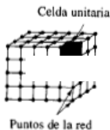
FIGURA 3-3 Una red es un arreglo periódico de puntos que definen un espacio. La celda unitaria (contorno grueso) es una subdivisión de la red que sigue conservando las características de la red.
