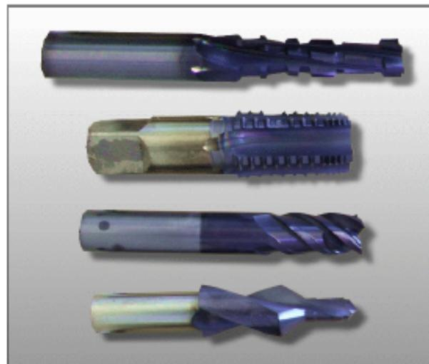
**Nitruro de Cromo (CrN)**  $\Rightarrow$  ampliamente utilizado en aplicaciones industriales donde es necesaria una buena protección contra la corrosión y una buena resistencia al desgaste adhesivo. Muy útil para el mecanizado de no ferrosos, especialmente aluminio y aleaciones de Ti.
