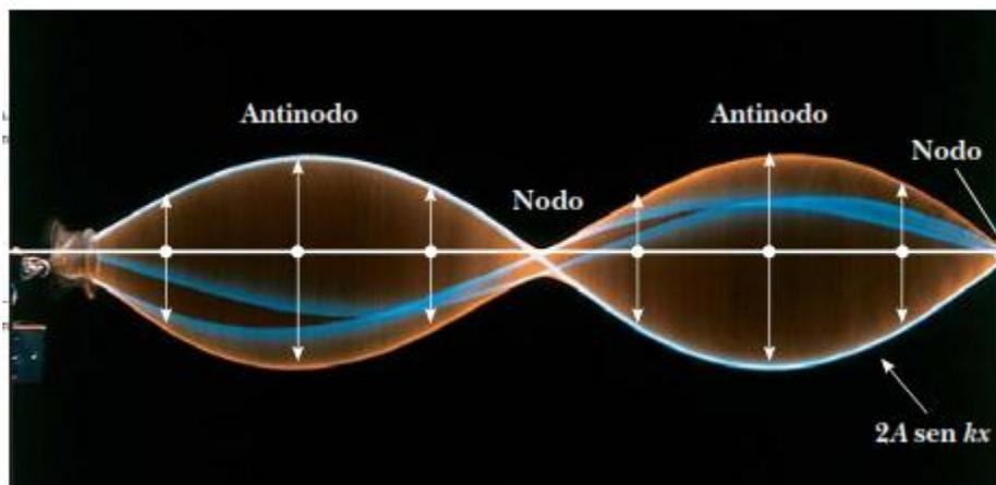
Fig.14. Fotografía múltiple de una Onda Estacionaria en una cuerda.
