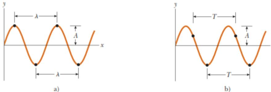
Fig.6. Modelo de una onda progresiva.
