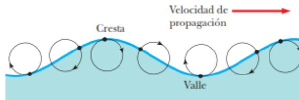
Fig.4. Ondas con desplazamientos transversales y longitudinales.
