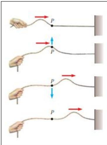
En la figura 2 se muestra este punto para un elemento particular llamado P. La dirección de movimiento de cualquier elemento P de la cuerda (flechas azules) es perpendicular a la dirección de propagación (flechas rojas).
