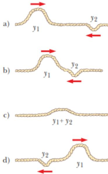
Fig.11. Superposición de Pulsos. Interferencia Destructiva
