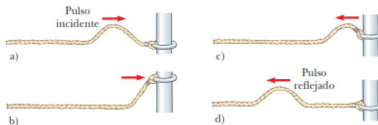
Fig.9. Reflexión de un pulso viajero en el extremo fijo de una cuerda estirada. El pulso reflejado no está invertido.
