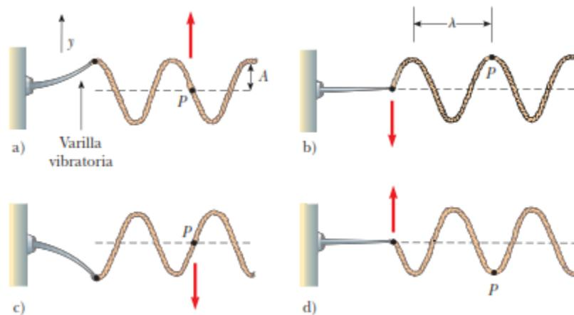
Fig.7. Modelo para producir una onda sinusoidal sobre una cuerda.
