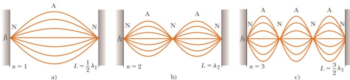
Fig.16. Modelo de Ondas bajo Condiciones de Frontera.
