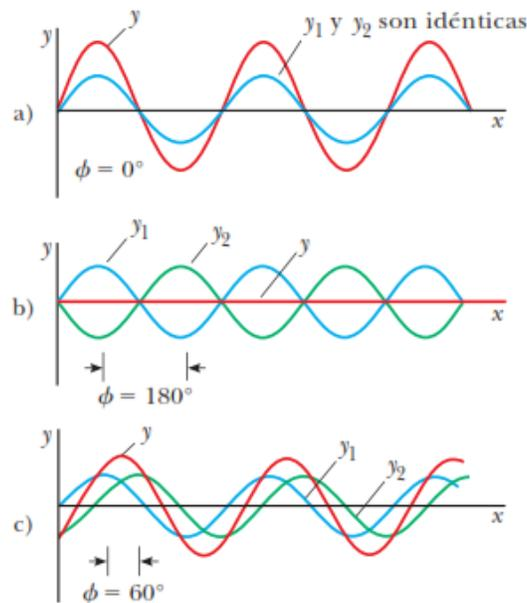
Fig.12. Superposición de Ondas Sinusoidales
