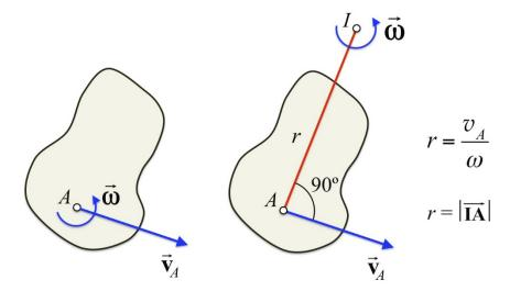
Si conocemos las velocidades de dos puntos del sólido A Y B, el CIR estará en la intersección de sus rectas perpendiculares a  $\overrightarrow{v_A}$  y  $\overrightarrow{v_B}$  en A y B.
