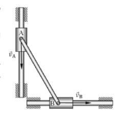
El movimiento general un sólido rígido consiste en una traslación y una rotación simultáneas y por lo tanto puede expresarse en cada instante como la superposición de una traslación de un punto de referencia arbitrario y una rotación alrededor del eje que pasa por dicho punto de referencia.
