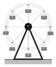
Los puntos A y B describen circunferencias iguales con sus centros desplazados, los puntos tienen velocidades y aceleraciones iguales y la posición del carrito es siempre horizontal (cualquier recta contenida en el cuerpo mantiene su dirección en el movimiento).
