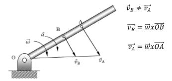
En el ejemplo de la Figura, la barra AB no tiene un movimiento de traslación ya que es evidente que los puntos A y B no tienen la misma velocidad y que la barra cambia de orientación en el movimiento. Sin embargo, tampoco se mueve con rotación pura ya que los puntos A y B no describen trayectorias circulares con eje común, por tanto puede deducirse que su movimiento es general.
