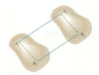
**Traslación rectilínea**: todos los puntos del sólido recorren trayectorias rectas y paralelas entre si.
