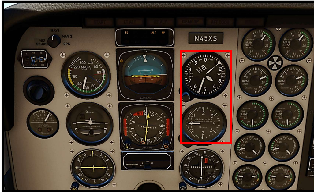
Ilustración 8: Altímetro en 13500 ft y variómetro en 0 ft/s.
