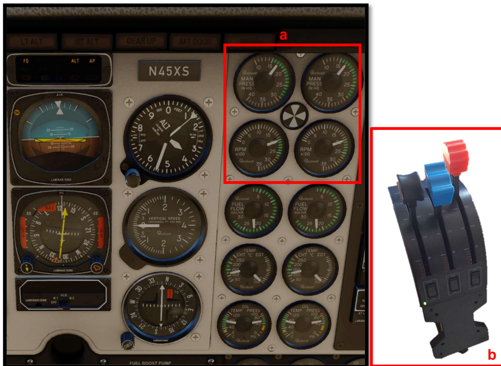
Ilustración 7: (a)Potencia del motor: 17 \times 20 ; (b)Configuración de Potencia [50%T, 50%P].
