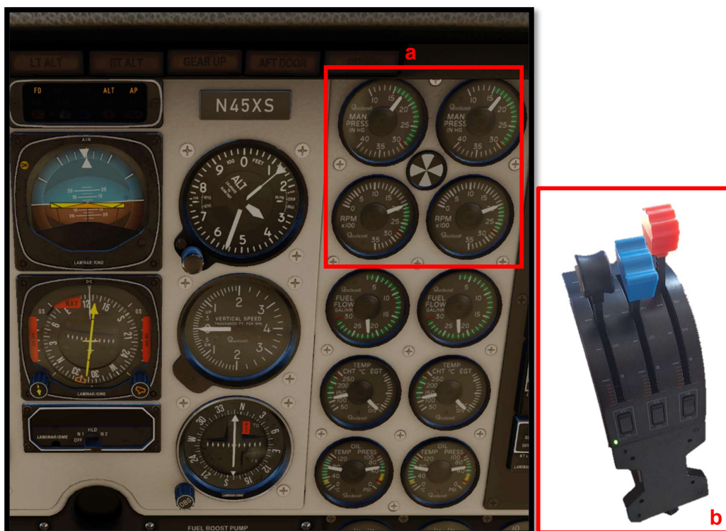
Ilustración 12: (a)Potencia del motor: 17 \times 20 ; (b)Configuración de Potencia [50%T, 50%P].
