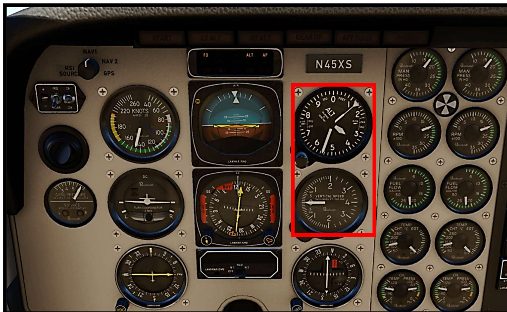
Ilustración 13: Altímetro en 13500 ft y variómetro en 0 ft/s.
