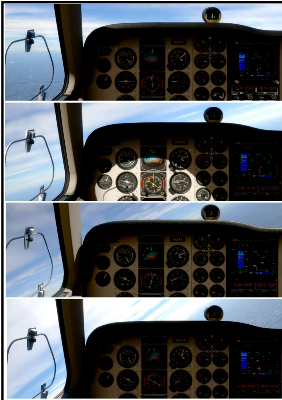
Ilustración 17: Vista interna de evolución de Divergencia en Espiral.
