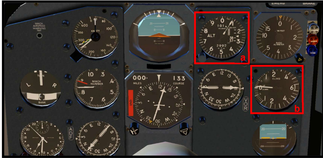
Ilustración 2: (a) Altímetro en 40000 ft \pm 100 ft; (b) Variómetro en 0 ft/s.
