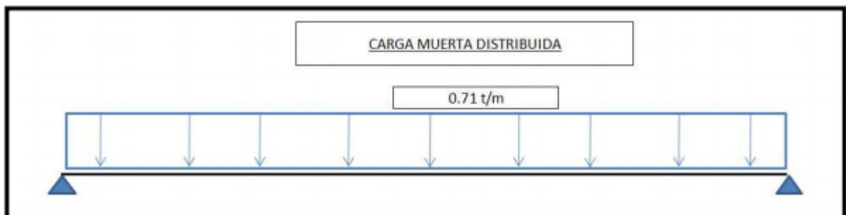
Fig. 13. Carga distribuida aplicada a una de las dos vigas principales.
