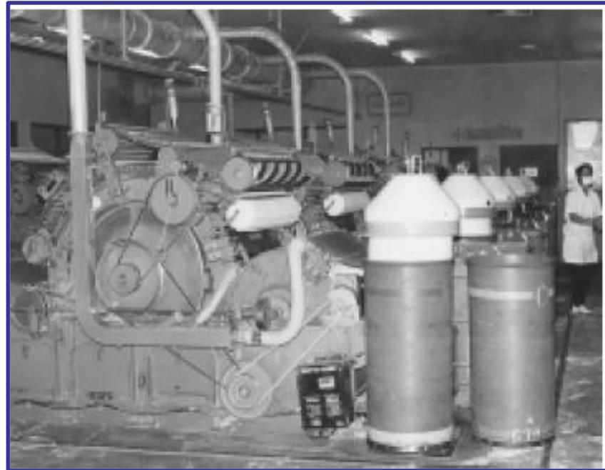
El peinado proporciona una limpieza más profunda que la carda. Elimina las fibras cortas, las motas y las impurezas, y el torzal resultante es muy limpio y lustroso.
