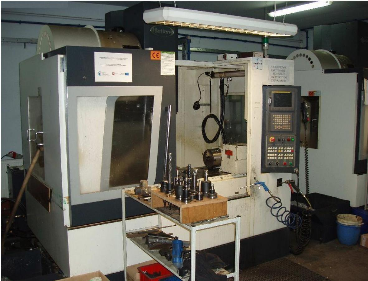
El Centro se desplaza en los ejes X, Y y Z, y tienen la posibilidad de agregar un eje mas (A) que se montaría (como se ve en la foto nuevamente) sobre el eje X. Si quisiéramos
