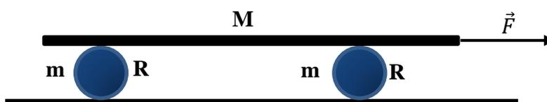
*Dato: Momento de inercia para un cilindro macizo respecto de un eje que pasa por su centro de masa y es perpendicular a las tapas:  $I_{CM} = \frac{1}{2}mR^2$*
