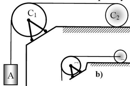
Considere la polea como un cilindro macizo y homogéneo sin rozamiento en su eje. Todas las masas tienen el mismo valor, y el cilindro  $C_2$  rueda sin resbalar en todos los casos. Para el cilindro:  $I_{CM} = \frac{1}{2}MR^2$   $R_{polea} = 20$  cm;  $R_{cilindro} = 10$  cm
