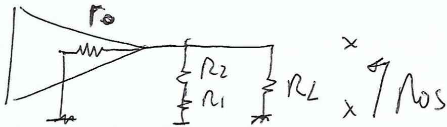
$$R_{os} = R_L // (R_1 + R_2) // r_o$$
