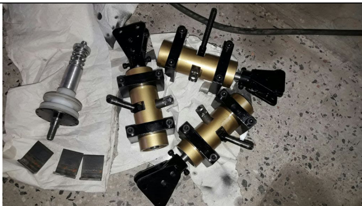
Semi armado de piezas mecanizadas del control de paso de pala centrífugo
