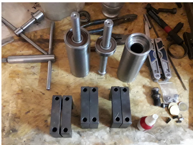
Despiece de cañoneras del control de paso de pala centrífugo
