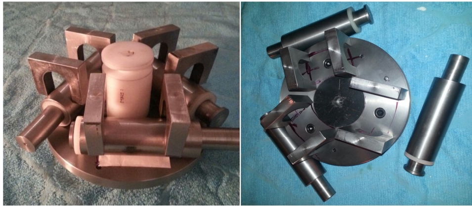
Figura 6, Mecanizado de control de paso de pala variable con centrífugo
