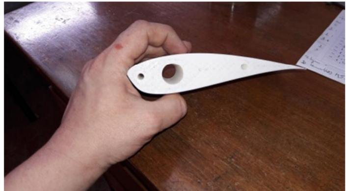
Perfiles aerodinámicos fabricados por el método de apilado de chapas de acero doble decapada cortadas con láser, en escala 0.3:
