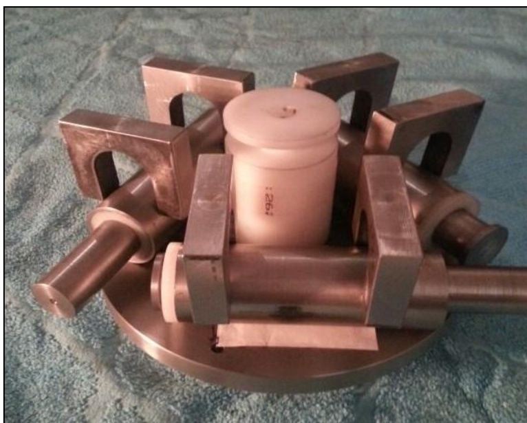
Mecanizado de cubo con propuesta de paso de pala con sistema centrífugo
