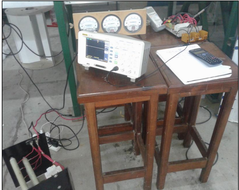
Mesa de trabajo, para ensayo en túnel de viento, con sistema eléctrico de aerogenerador e instrumentos de medida.
