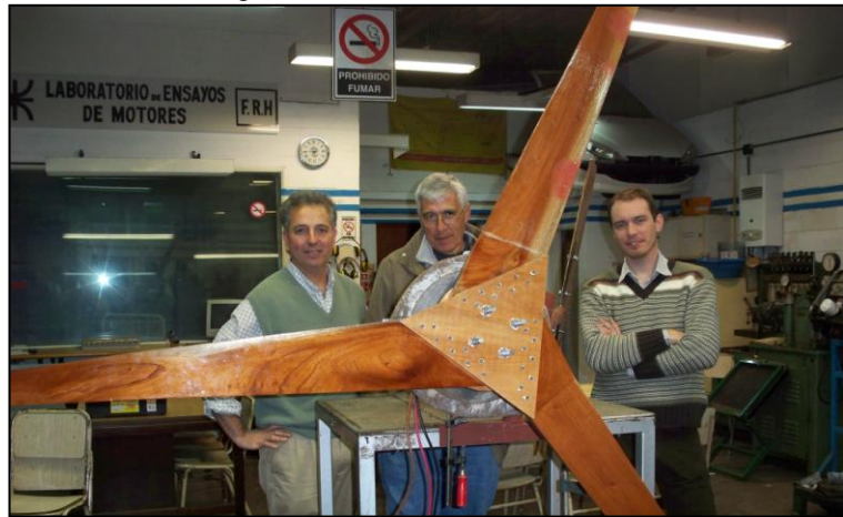
Prototipo aerogenerador 700 W de paso fijo
