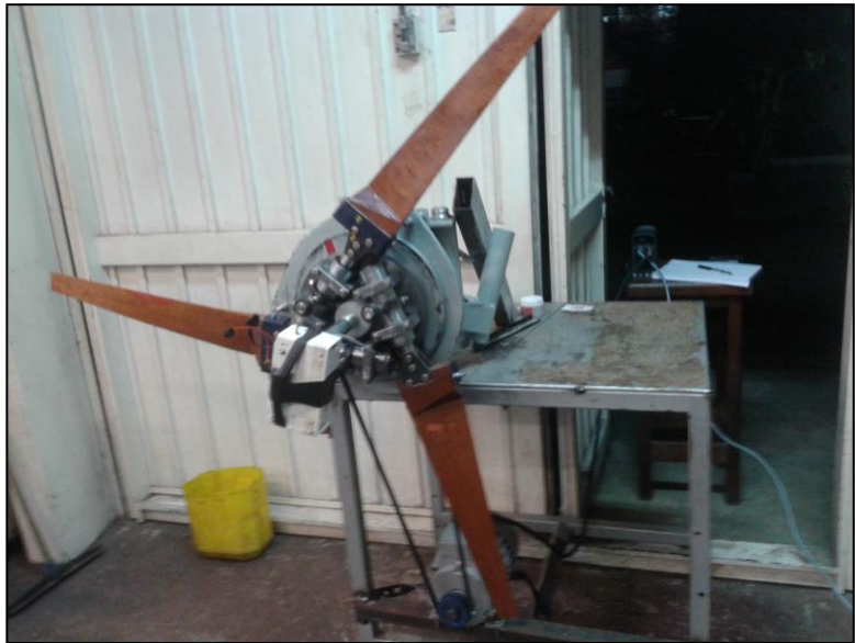
Ensayo de prototipo aerogenerador con control de potencia por paso variable a través de control centrífugo en banco de prueba
