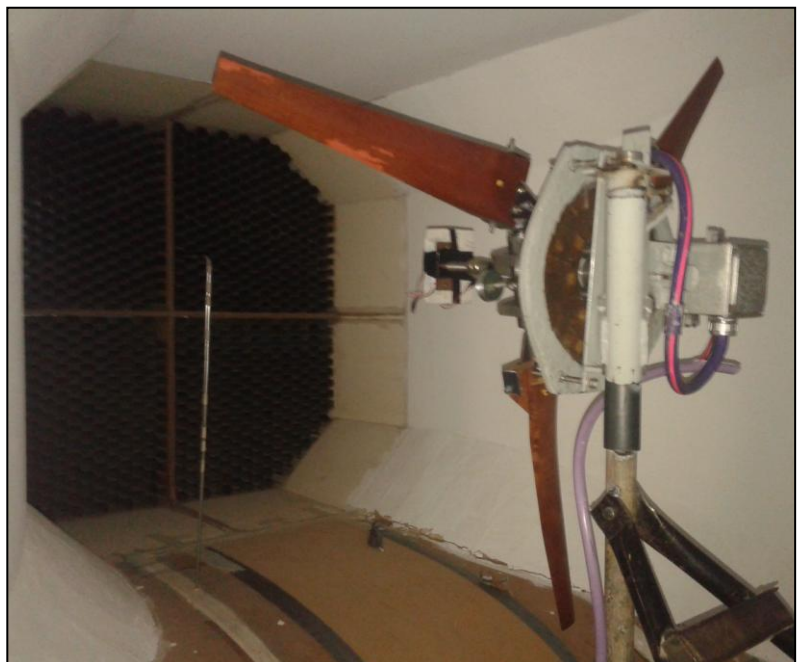
Prototipo aerogenerador montado en túnel de viento para su ensayo
