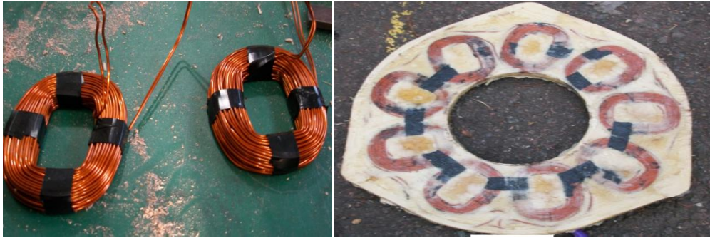
Figura 2 Armado de estator, a) Bobinas de fase, b) Estator completo
