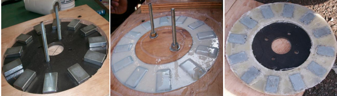
a) Ubicación de imanes y preparación del molde, b) llenado del molde, c) Disco con imanes terminado.
