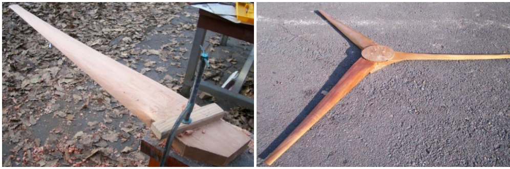
Figura 3, Construcción de rotor, a) Elaboración de palas, b) Ensamblado de Rotor
