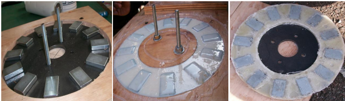
a) b) c) Figura 1 montaje de imanes sobre disco de acero, a) Ubicación de imanes y preparación del molde, b) llenado del molde, c) Disco con imanes terminado.
