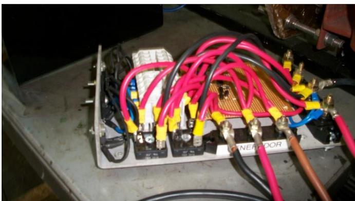
**Placa electrónica de control aerogenerador**
