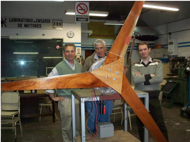
**Prototipo aerogenerador de paso fijo de 700W**
