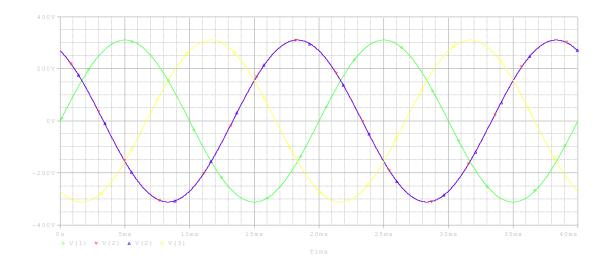
Si sumamos dichas señales en el tiempo para el esquema anterior punto a punto nos da que dicho valor es cero. Por lo tanto tenemos un sistema equilibrado en tensión en donde el terminal del conductor de neutro respecto a la referencia de tierra mantendría dicho valor , todo esto en el caso de un sistema seguramente sin consumo o con cargas lineales y perfectamente equilibradas.
