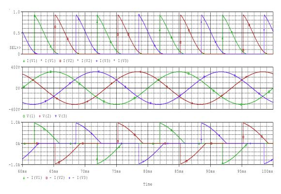
En la segunda curva tenemos la alimentación fase neutro con el correspondiente desfase, en la última curva la corriente que veríamos circular por nuestro conductor de neutro y la primer curva la suma cuadrática de dicha corriente.
