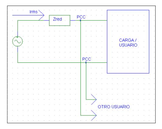
Por lo tanto es necesario una Potencia de cortocircuito importante de manera que redunde en una baja impedancia de red, evitando de esta manera los perjuicios de los armónicos de tensión, esto no significa que no se puedan provocar dentro de la instalación si esta última esta mal dimensionada, por lo tanto es muy importante estudiar esto último.
