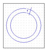
Tanto para una sección como para la otra la penetración x no cambia . por lo tanto aumenta la Rca respecto a la Rcc para el conductor en cuestión. A medida que aumentamos la sección, la Rca disminuye, pero para una misma frecuencia cuanto mayor sea la sección del conductor mayor será la relación entre la Rca y su respectiva Rcc. Es por ello se establece la siguiente expresión general:
