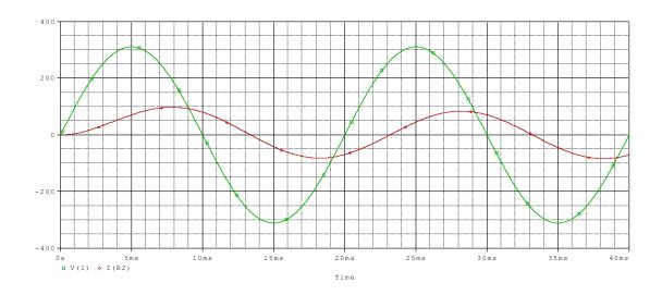
Hay un ángulo de corrimiento entre una y otra, o dicho de otra manera cuando una esta, por decir, en un máximo la otra pasó ya dicha condición.
