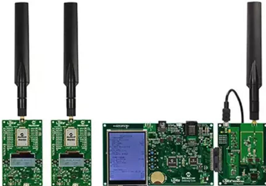
*Figura 8: Los kits de evaluación LoRa DV164140-2 (915MHz) y DV164140-1 (868 MHz) de Microchip incluyen dos placas Mote una placa núcleo de compuerta, y la placa de radio (de izquierda a derecha). (Fuente de la imagen: Microchip Technology)*
