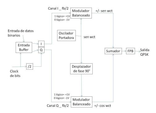
Los datos de entrada son agrupados en **dibits** en el buffer, al que llegan en forma serial para salir simultáneamente en paralelo. El bit "I" modula una portadora que esta en fase con el oscilador de referencia y el bit "Q" la otra que está en cuadratura.
