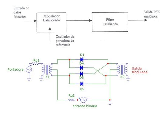
La entrada binaria, debe tener un valor de amplitud mayor que la portadora, de forma tal que controle el encendido y apagado de los diodos.
