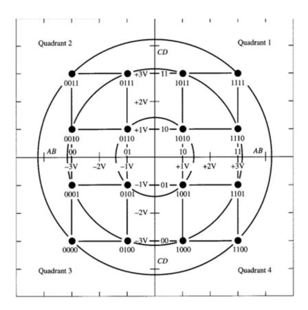
Se produce un cambio de fase o amplitud o ambas cada cuatro bits. En consecuencia la velocidad de señalización o tasa de baudios y el ancho de banda resultan 1/4 de la tasa de bits.
