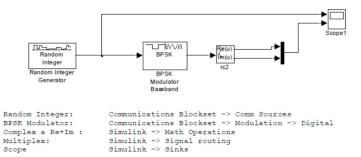
El generador debe producir un alfabeto de dos valores (2-ary). Utilizar un Ts=1E-3. En el modulador se puede variar la fase.
