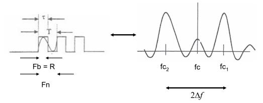
Como se ve en el espectro hay dos señales alrededor de una portadora "virtual". Para hallar el ancho de banda se seguirá un tratamiento similar al de la FM analógica, es decir en función del " $\beta$ "
