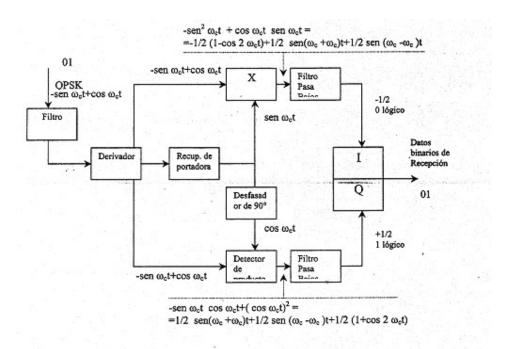
Para visualizar el funcionamiento del detector de QPSK supongamos estar recibiendo la señal
