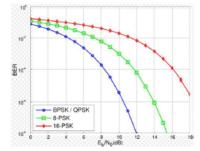
EJERCICIO: Veamos la probabilidad de error de bit con el siguiente modelo. Construir el modelo y variando Eb/No del bloque AWGN, obtener y representar la curva BER=f(Eb/No (dB)). Comprobar la potencia de la señal de salida del modulador.
