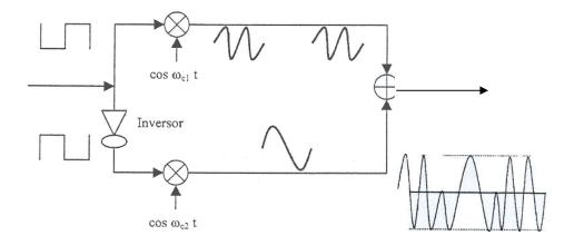
Básicamente, cada cambio en el tren de pulsos provoca un cambio en la frecuencia portadora
