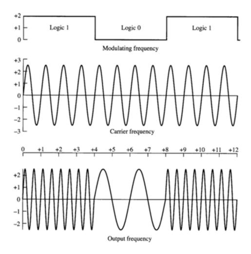
Este tipo de circuito produce transiciones bruscas en el cambio de frecuencia, que aumentan el ancho de banda.
