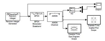
Uno de los parámetros fundamentales de los diferentes tipos de modulación es la tasa de error, BER (Bit Error Rate). Normalmente BER se da en función de la calidad de señal recibida, es decir, en función del ratio Eb/No. Para BPSK se demuestra que esa tasa de error es:
