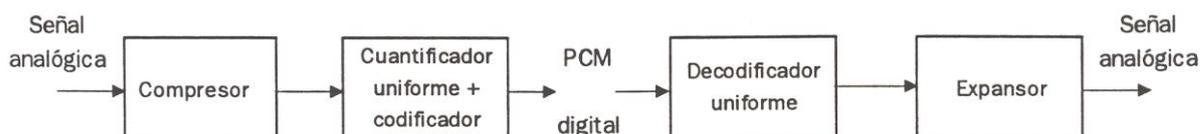
La característica no lineal del compresor tiene como efecto modificar la función densidad de probabilidad de la señal de entrada. Esta resulta comprimida en sus niveles más altos, y el compresor provee mayor ganancia a los bajos niveles de la señal de entrada que a los altos.
