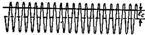
(d) TENSION QUE ACTUA EN LA REJA DE CONTROL POLARIZACION FIJA Y REGULACION PERFECTA DE LA TENSION DE RF
