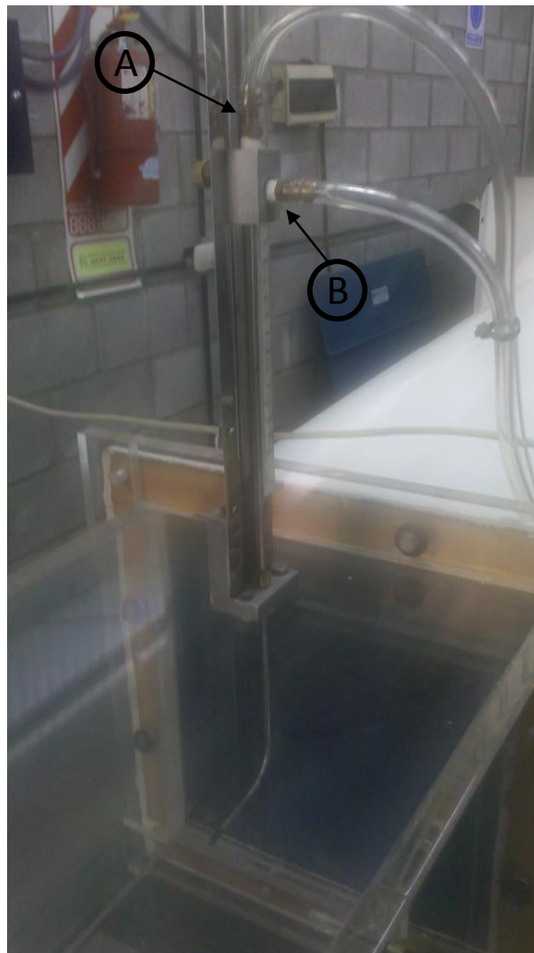
Figura 3.3.2: Tubo Pitot estándar usado en el laboratorio.
