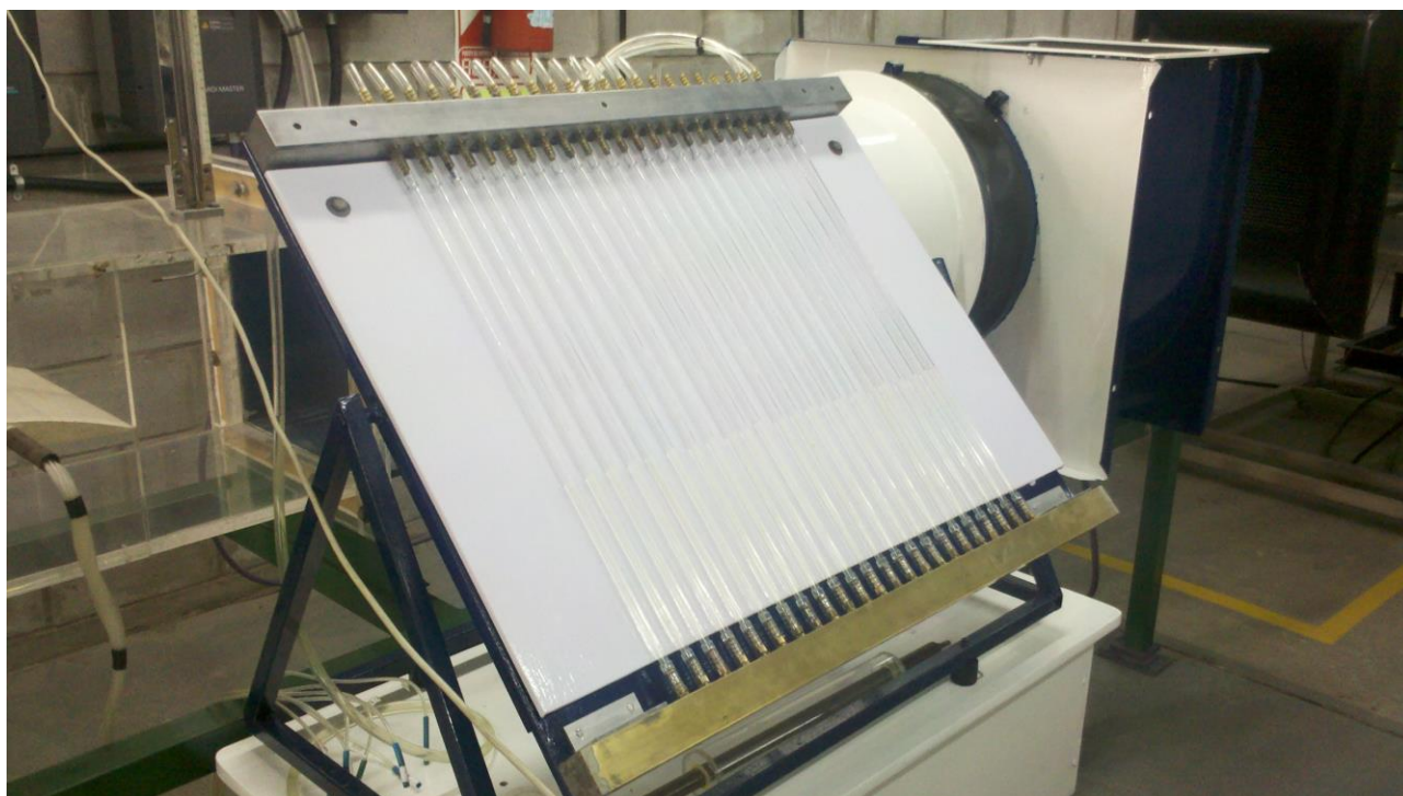
Figura 3.2.2: Manómetro diferencial usado en el laboratorio, nótese las múltiples columnas y la inclinación a 45°.
