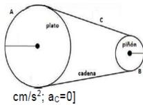
49.- En la figura se representa esquemáticamente el sistema de transmisión de una bicicleta. El plato gira con  $\omega = 0,9 \text{ 1/s}$  y su radio es 10 cm. El radio del piñón es 3 cm. Calcular: a) El módulo de la velocidad tangencial de un eslabón de la cadena en los puntos A, B y C; b) la velocidad angular del piñón; c) el módulo de la aceleración del eslabón en cada punto. [a] 9 cm/s en A, B y C; b) 30 1/s; c)  $a_A = 8,1 \text{ cm/s}^2$ ;  $a_B = 2700$
