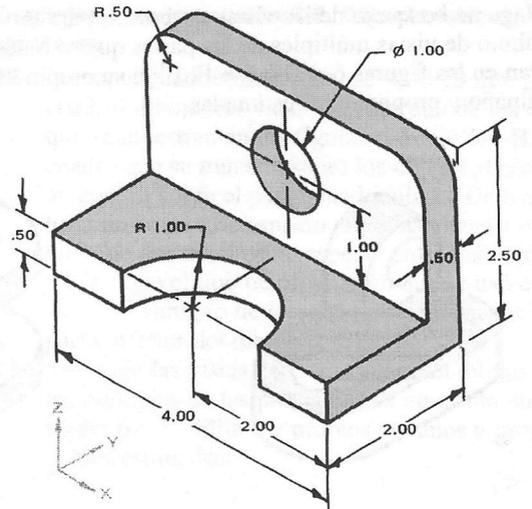
Figura 6-6-J Soporte de rodamiento.
