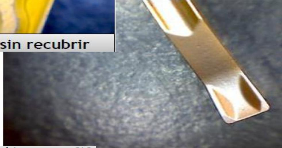
insertos recubiertos con SiC.
