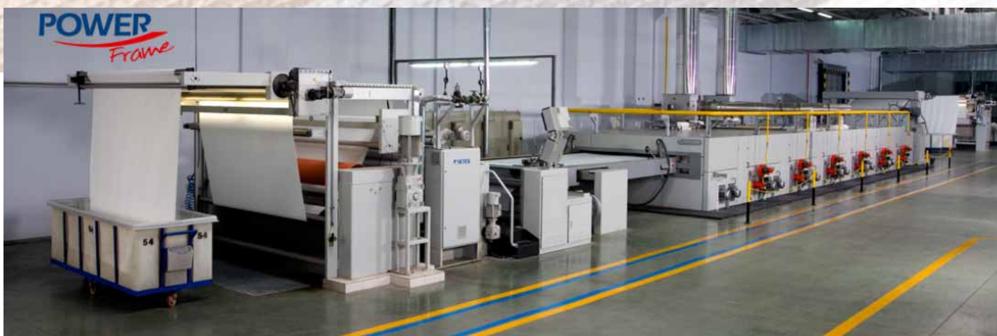
Fig.9 Rame de cadena transportadora vertical y Fouldard
