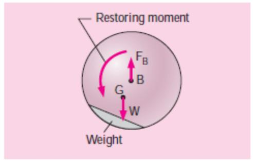
“Cuando el centro de gravedad  $G$  de un cuerpo inmerso totalmente, es no alineado verticalmente con el centro de flotabilidad  $B$  del cuerpo, no está en un estado de equilibrio y rotaría a su estado estable, incluso sin ningún disturbio”
