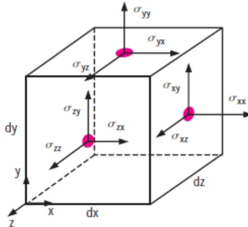
Las Fuerzas Superficiales Normales y Viscosas surgen a partir de **integrar en el área al tensor de tensiones**. Este tensor tiene como componentes en su diagonal a las **tensiones normales (Presiones) + las tensiones viscosas**. Fuera de su diagonal se encuentran las **tensiones de corte**.
