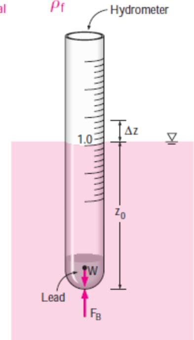
“Las fuerzas de empuje ( $F_B$ ) que actúan sobre un cuerpo sólido sumergido en un fluido y en un cuerpo fluido de la misma forma en la misma profundidad es idéntica”
