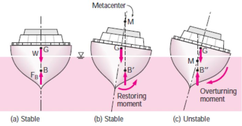
(b) Un cuerpo flotante es estable si el cuerpo es de fondo pesado y por lo tanto el centro de gravedad  $G$  está debajo del centro de flotación  $B$  del cuerpo, o si el metacenter  $M$  esta sobre el punto  $G$ .
