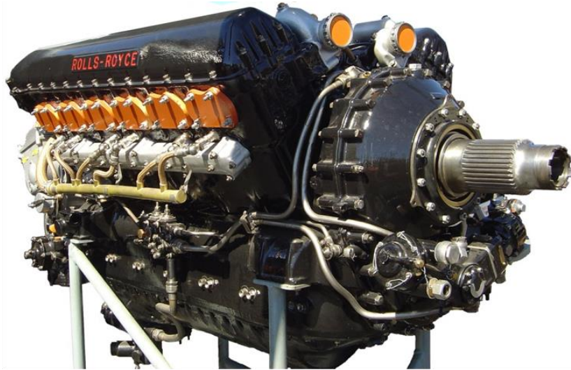
Rolls-Royce Merlin, un motor en configuración V12 refrigerado por líquido.
