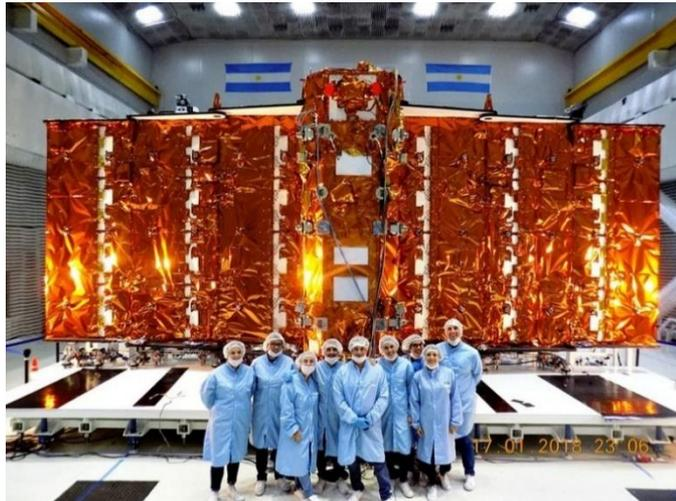
**Mantas Térmicas:** tienen como objetivo principal proporcionar aislamiento térmico, protección contra el calor y, en algunos casos, aislamiento acústico a las estructuras y equipos en el espacio o en ambientes extremadamente fríos. Estas mantas ayudan a mantener las temperaturas dentro de un rango adecuado para el funcionamiento de los equipos o para garantizar la supervivencia de los sistemas y dispositivos electrónicos.
