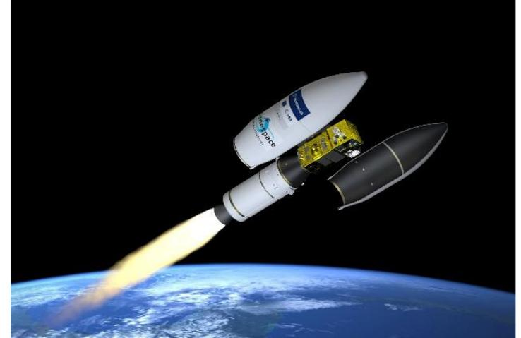
**Dispositivo de despliegue** es un mecanismo instalado en el lanzador espacial que permite la liberación controlada de satélites en órbita. Puede operar mediante resortes, pestillos mecánicos o sistemas pirotécnicos, y su diseño varía según el tipo y cantidad de cargas útiles. Su correcta activación garantiza una separación segura, evitando interferencias o colisiones durante el despliegue.
