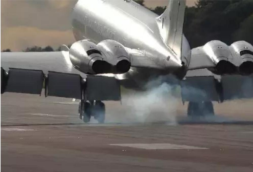
Este avión de cuatro motores y tiene reversor en los dos motores externos únicamente.
