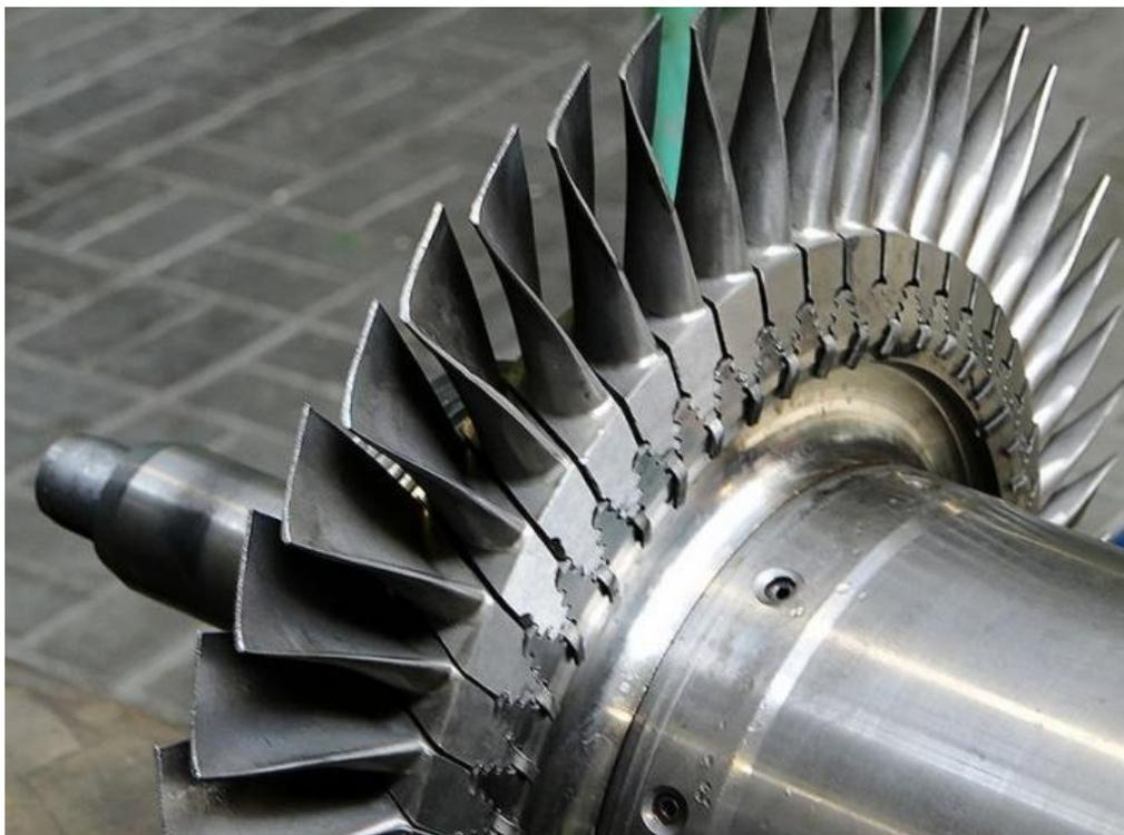
Podemos observar cómo están montados los álabes en el disco rotor y se puede apreciar las diferencias en espesor de la raíz a la puntera. Los espesores son mucho más gruesos y con otro tipo de curvatura en la raíz. El encastre es similar a un árbol de pino. Se encastran y después se aseguran con diferentes tipos de seguros.
