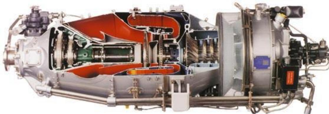
El aire ingresa por la rejilla de ingreso del aire, pasa por el compresor axial, por el compresor centrífugo; de este último compresor pasa al difusor, al colector dirige el fluido a la cámara anular, va a la turbina que va a manejar a los compresores y pasa por la segunda turbina, que está desacoplada (no tiene el mismo eje), y esta turbina (que es por donde pasa el fluido, por la segunda turbina) es la que a través de este eje mueve la caja reductora y de ahí mueve la hélice.
