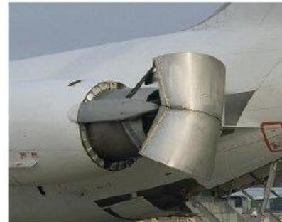
En este caso directamente se abren dos placas desviando el flujo de gases de escape produciendo la inversión del flujo. En este caso, no solo es aire caliente, sino que también estamos desviando el flujo de aire frío. Luego de armar el reversor, el motor nuevamente se vuelve a acelerar.
