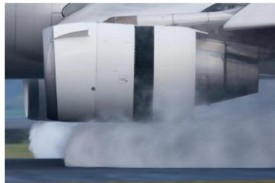
En este caso lo que se hace es desviar el flujo de aire frío del fan. Cuando se acciona el reversor, se incrementa la velocidad del aire a través del incremento de las rpm del motor y lo que busco es que se desvíen, la placa mueve su posición y desvía el aire produciendo un vector fuerza en el sentido contrario al avance del avión.
