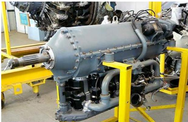
El Ranger L-440 es un motor invertido de seis cilindros en línea refrigerado por aire, fabricado por la Ranger Aircraft Engine Division. El motor fue producido principalmente para la familia de aviones de entrenamiento de Fairchild en la década de 1930.
