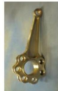
En el interior de un motor radial o estrella simple apreciamos que posee un cigüeñal con una sola manivela, sobre ese cigüeñal se encuentra montada una biela, denominada biela maestra. Sobre la biela maestra están ubicadas las bielas correspondientes al resto de los pistones. Un solo pistón va montado a la biela maestra y el resto de los pistones se encuentran unidos a la biela maestra por bieletas. La biela maestra es la que se encuentra montada a la manivela del cigüeñal.
