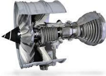
Por último, tenemos **por variación de la cantidad de movimiento del propio sistema**. La masa se va consumiendo, en ese consumo se produce una aceleración de ese gas que se va generando y esa acción del movimiento produce la reacción en sentido contrario del desplazamiento del sistema.
