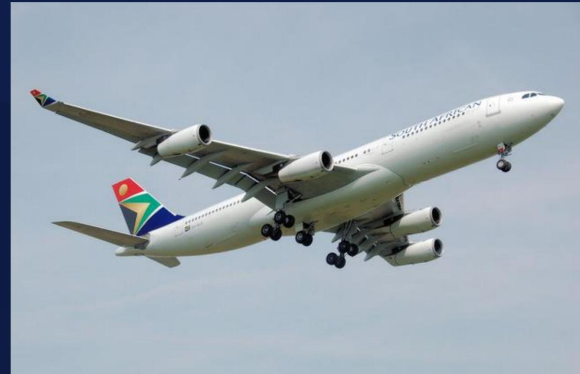
Airbus A340-200 – Aeronave de largo radio de alcance de fuselaje ancho y 4 motores (1993). 261 PAX.
