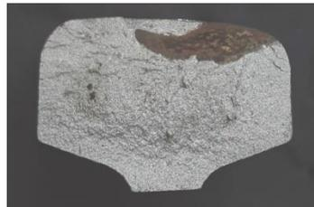
Figura 12: Superficie de fractura iniciada en un head check, en laboratorio, [13].
