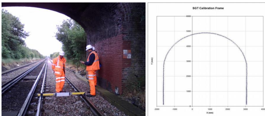
Figura 45. Inspección de gálbos por tiempo de vuelo [39].
