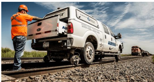
Figura 26. Izquierda: Camioneta adaptada para realizar inspecciones en rieles ferroviarios [31]. Derecha: Dispositivo retráctil que se adapta a la camioneta [32.]
