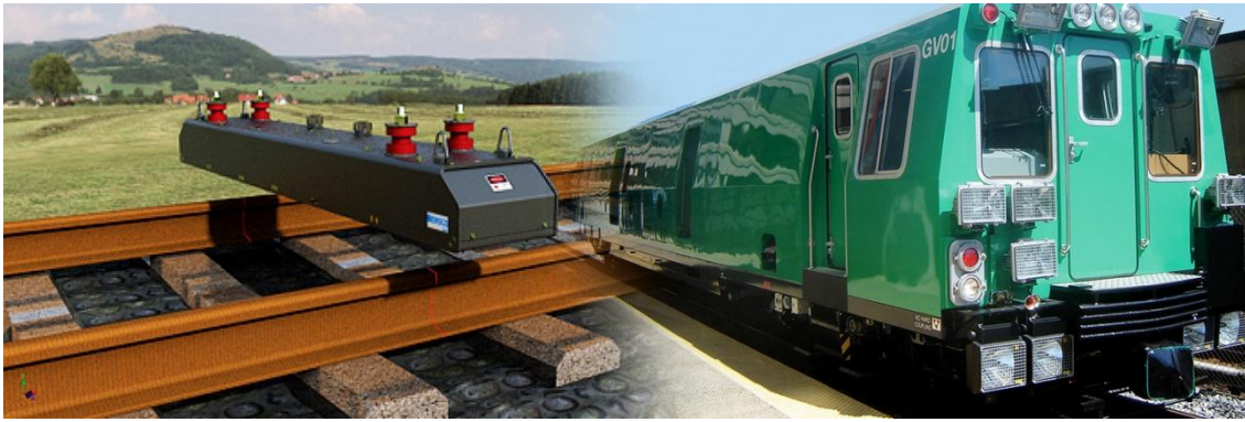
Figura 27. Sistema de inspección óptico – laser adosado a la estructura del tren con motorización independiente [33]
