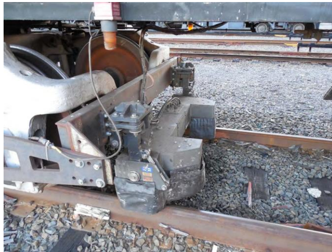
Figura 28. Detalle de instalación de sistema de inspección adosado a la estructura del bogie [12]
