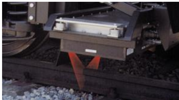
Figura 31. Sistema de medición de geometría de vía.
