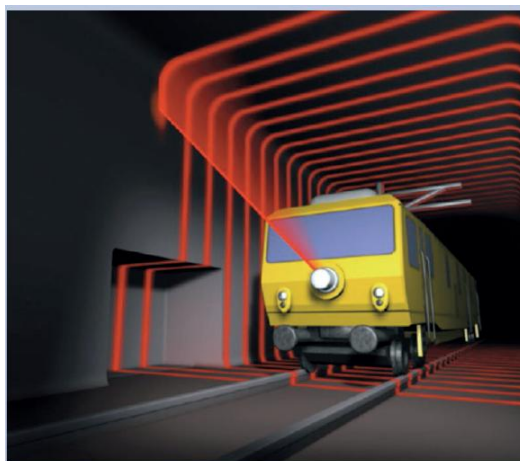
Figura 44. Medición de túnel mediante proyección de punto láser con método de tiempo de vuelo [41]
