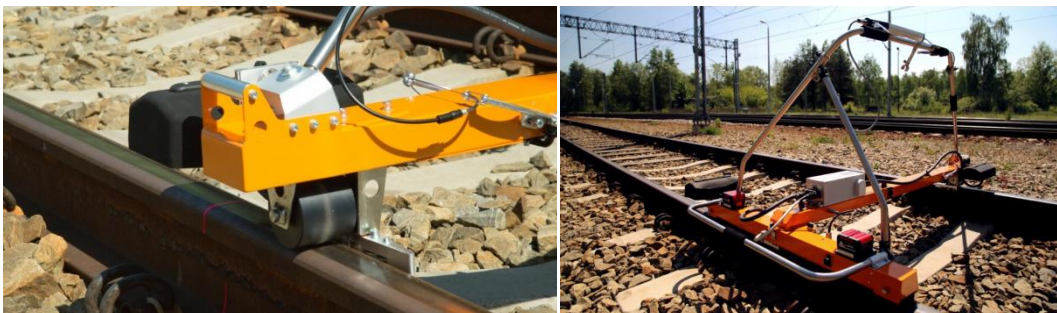
Figura 25. Sistema de trole de escaneo mediante triangulación laser [30].
