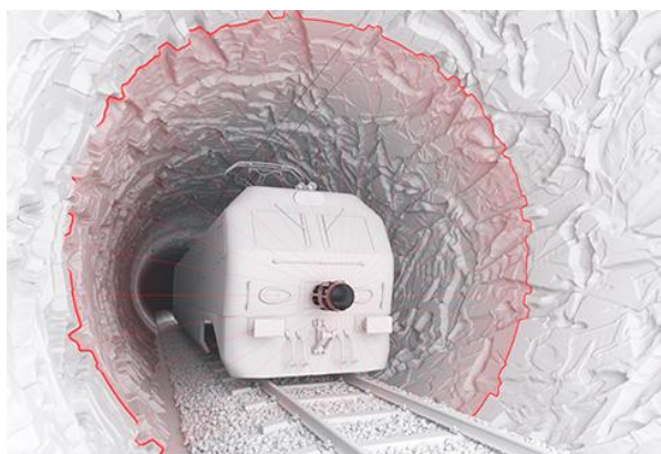
Figura 44. Medición de túnel mediante proyección de conos de luz mediante triangulación láser [34]
