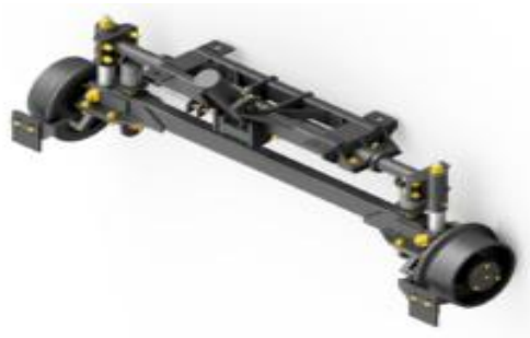
Figura 26. Izquierda: Camioneta adaptada para realizar inspecciones en rieles ferroviarios [31]. Derecha: Dispositivo retráctil que se adapta a la camioneta [32.]
