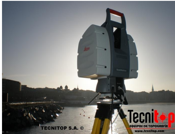
Figura 5. Equipo de escaneo láser por tiempo de vuelo [18].
