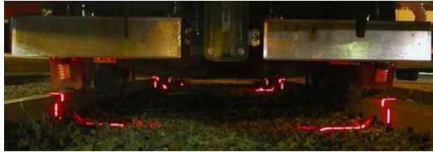
Figura 29. Sistema de medición de cuerda en tres puntos [12]
