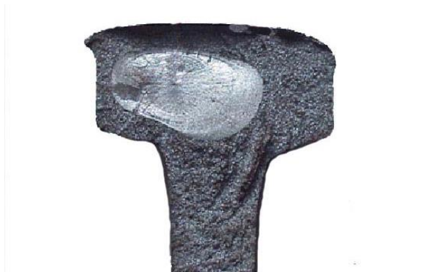
Figura 39. Detalle de fractura iniciada en un poro.
