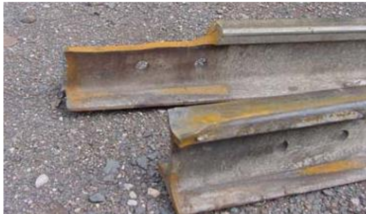
Figura 50. Separación del alma y la cabeza en el extremo del riel.
