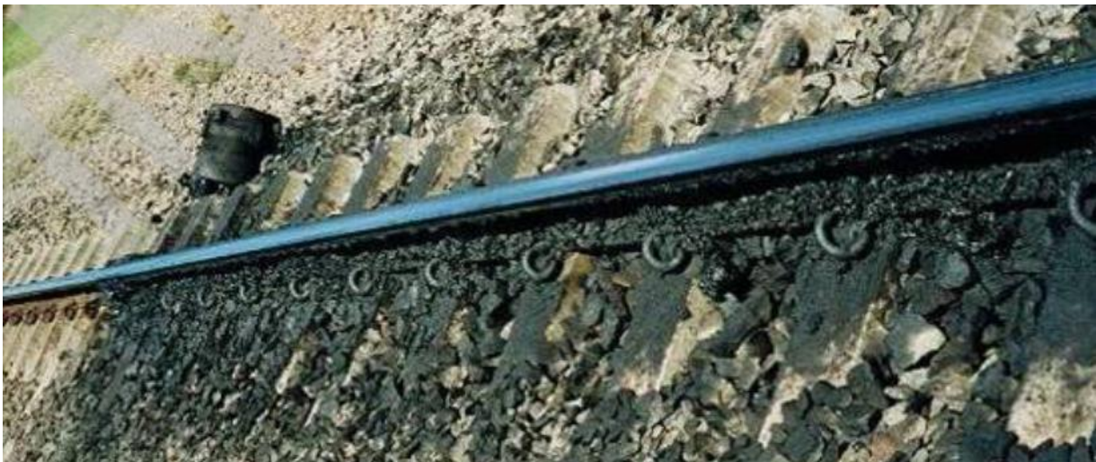
Figura 38. Superficie de rodadura contaminada con sustancias lubricantes, [3].
