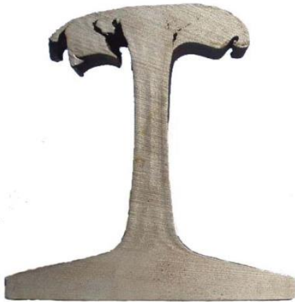
Figura 48. Corte o cizallamiento.
