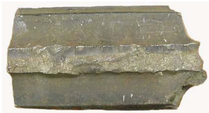
Figura 49. Separación del alma y la cabeza, mostrando progresión en el alma.
