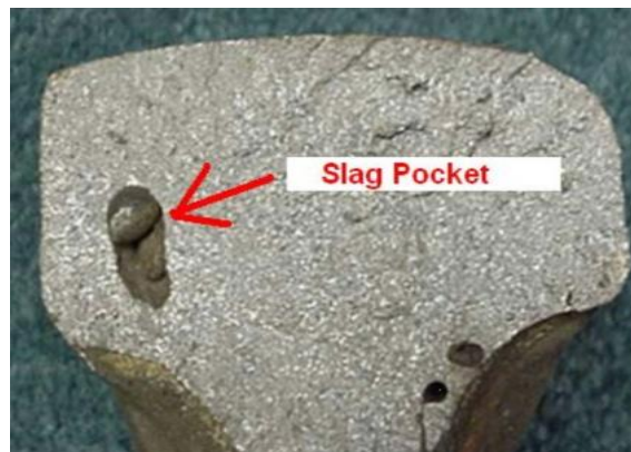
Figura 57. Falla en una soldadura aluminotérmica iniciada en escoria atrapada.
