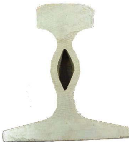
Figura 43. Abombamiento del alma por presencia de una cavidad.
