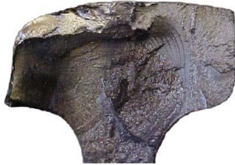
Figura 15. Fractura compuesta, con un detalle de fractura en múltiples etapas, [13].
