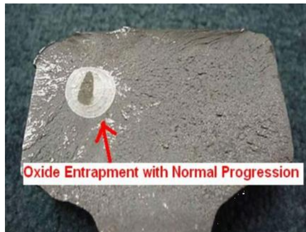
Figura 59. Falla en una soldadura a tope por flash eléctrico iniciada en óxido atrapado.
