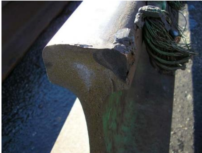
Figure 62. Defecto transversal desarrollado a partir de una conexión eléctrica.
