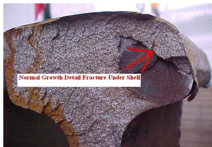
Figura 31. Detalle de fractura originada en un shell de la esquina de trocha, [13].
