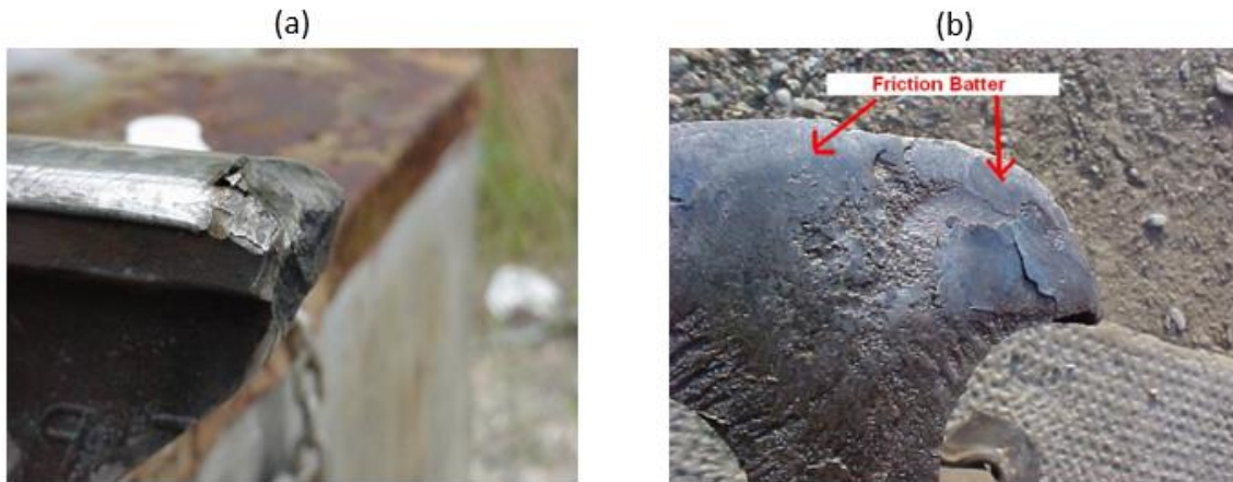
Figura 54. (a) abolladura por impacto de las ruedas; (b) abolladura por fricción, [4].
