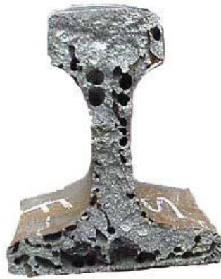
Figura 58. Soldadura aluminotérmica mostrando porosidad severa.
