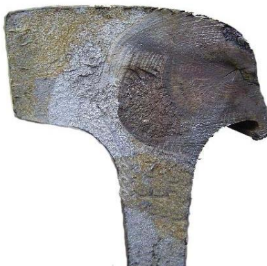
Figura 47. Detalle de fractura inversa.
