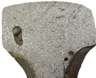
Figura 14. Detalle de fractura frágil, [12]. Soldadura aluminotérmica con escoria atrapada.
