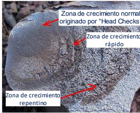
Figura 3: Detalle de fractura iniciada desde un “head check”, [5].
