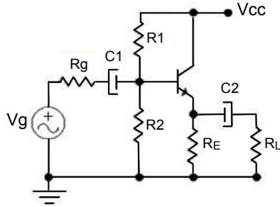
Al capacitor  $C_e$  no se le puede aplicar el teorema de Miller porque  $A_v=1$
