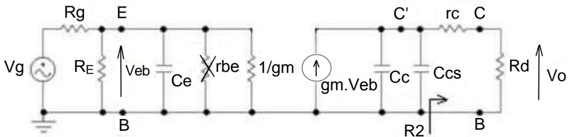
Despreciamos  $1/h_{ob}$ ,  $r_c$  y  $C_{cs}$  solo para transistores integrados.
