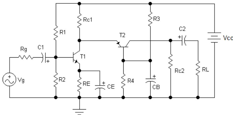
El circuito está compuesto por un EC seguido de un BC que están acoplados en DC.
