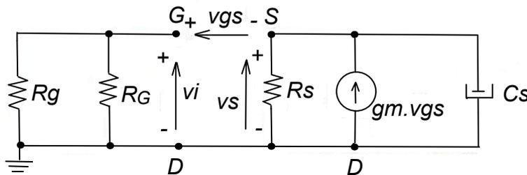
Al ser  $v_{gs} = v_i - v_s$  como  $v_i = 0V \rightarrow$   $v_{gs} = -v_s$
