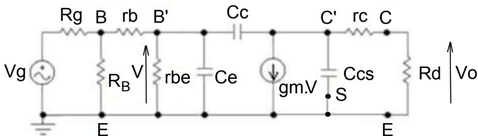
Despreciamos  $1/hoe$ ,  $rc$  y  $Ccs$  solo para transistores integrados.
