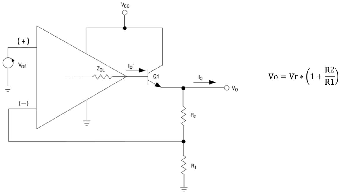
Ilustración 5 Regulador serie con OPAMP + Transistor de salida
