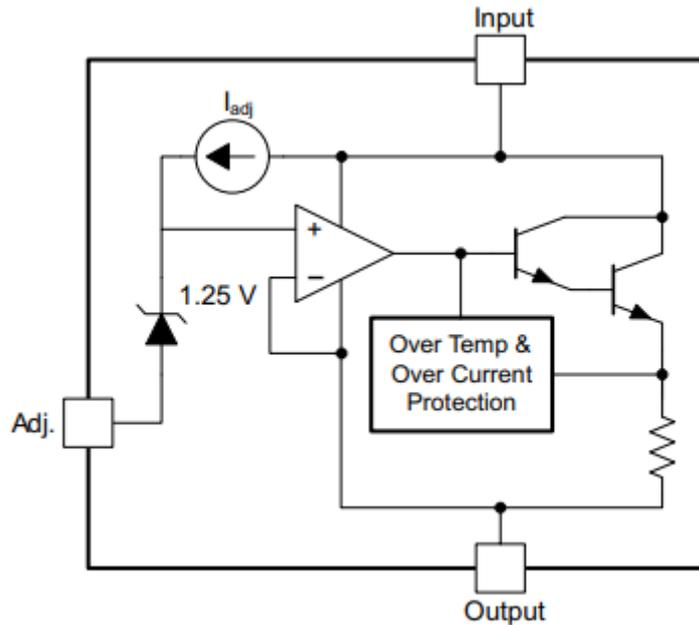
Ilustración 11 Diagrama en bloques del regulador serie LM317
