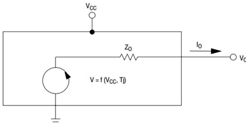
Ilustración 2 Modelo real de un regulador serie
