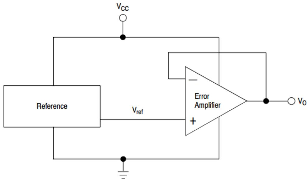
Ilustración 1 Diagrama en bloques de un regulador serie
