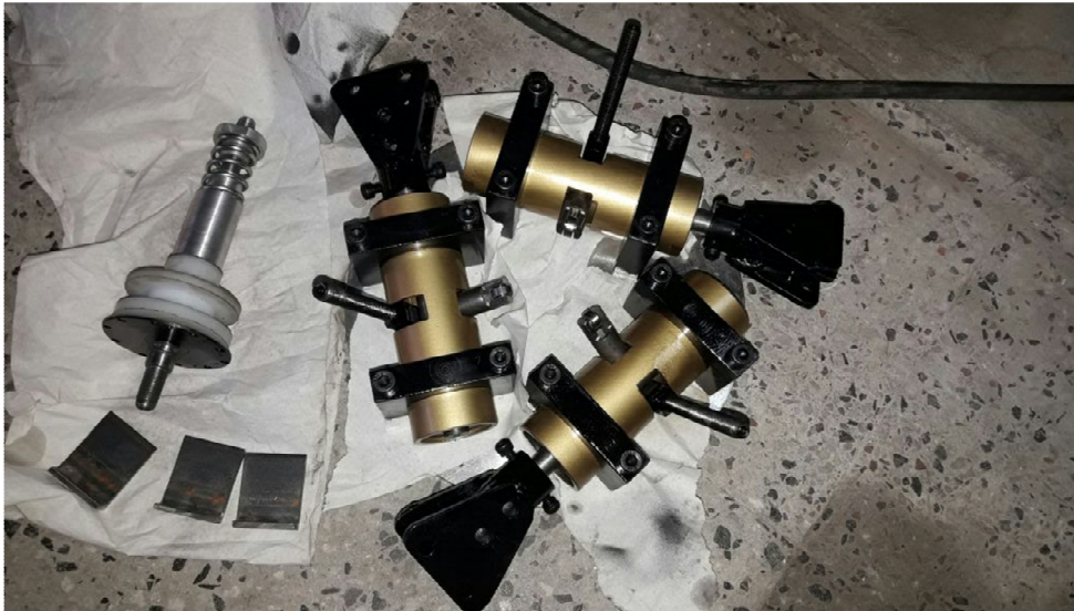
Figura 2. Piezas mecanizadas del control de paso de pala centrífugo
