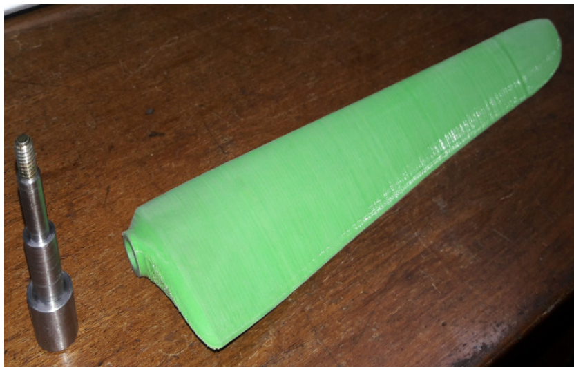
Figura 11 Impresión de palas 3D
