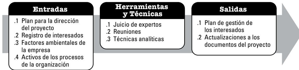
Gráfico 13-5. Planificar la Gestión de los Interesados: Entradas, Herramientas y Técnicas, y Salidas
