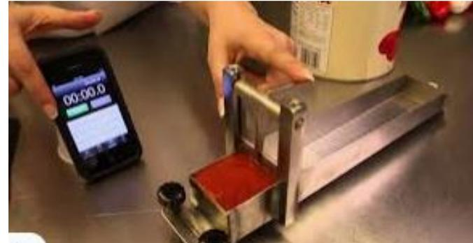
El viscosímetro Bostwick permite un procedimiento de medición rápido y sencillo para determinar las propiedades de flujo de sustancias fluidas viscosas. Con el viscosímetro Bostwick se determina en un proceso de comparación física el recorrido de flujo en un tiempo determinado de un líquido que se extiende o de un material pastoso
